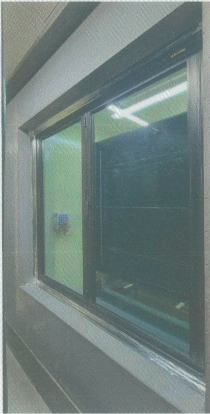
<사진 1> 열관류율 향온측 시험체 사진
