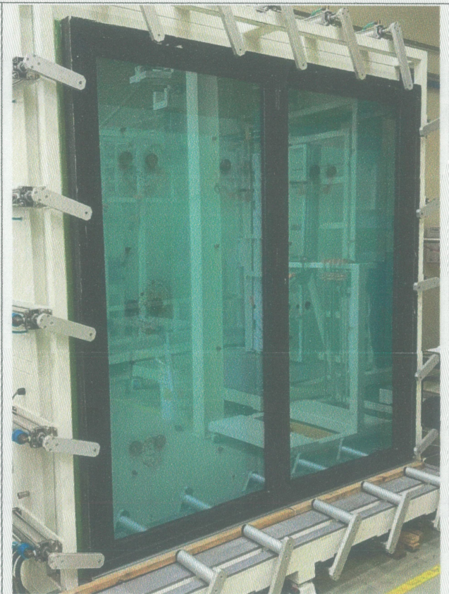
<사진 2> 기밀 시험체 사진(측면)
