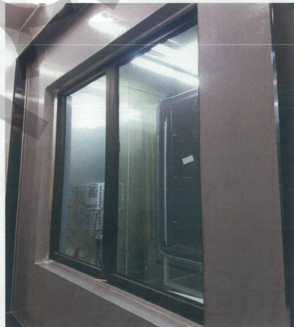
<사진 4> 저온측 시험체 모습 (열관류율)
