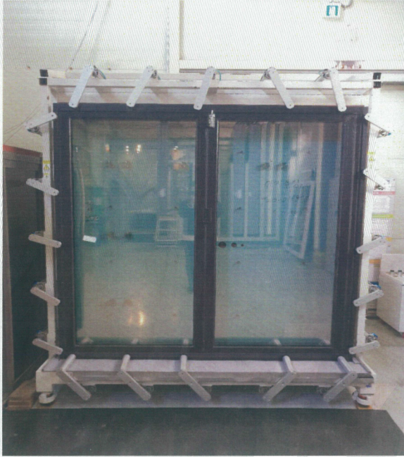
<사진 1> 시험체 정면 (기밀)
