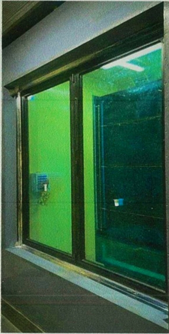
<사진 1> 열관류율 향온측 시험체 사진
